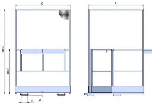
Die Arbeitsbühne T 197 2 besteht aus einer geschlossenen Bodenplatte, einem Fußschutz, einem oberen und einem mittleren Geländer.
